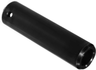
830.601 = PINO DO PATIM DO FREIO VOLVO TRASEIRO (30 X 18 X 115) CEMENTADO Nº. ORIG. (1.586.716)
