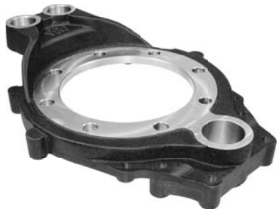
674.703 = FLANGE DO FREIO MASTER / RANDON APÓS 1988 (8 FUROS)
