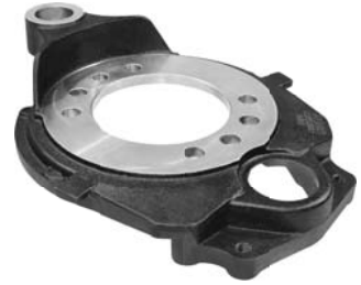
674.608 = FLANGE DO FREIO TRUCK BENDIX / F-12000 / F-14000 / F-12000L + 60X / F-12000L + 60Y (8 FUROS) DIREITO Nº. ORIG. (T12-607.022-A)
